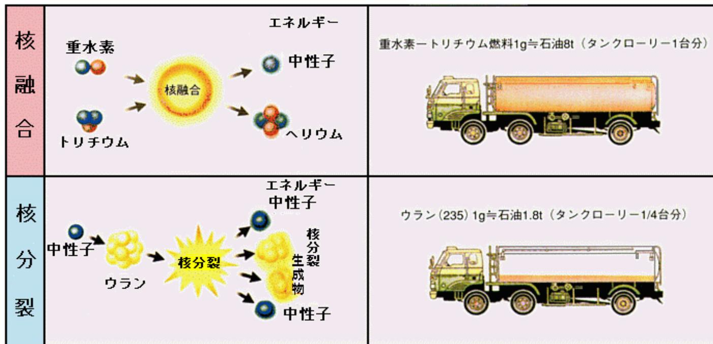
図1 核融合と核分裂の原理と発生エネルギー量
