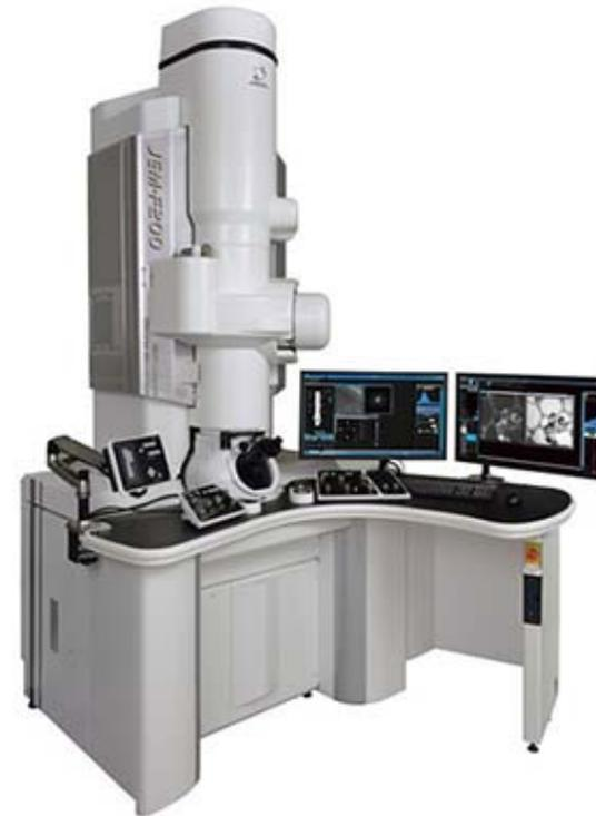
多機能電子顕微鏡「JEM-F200」 出典：物質・材料研究機構
